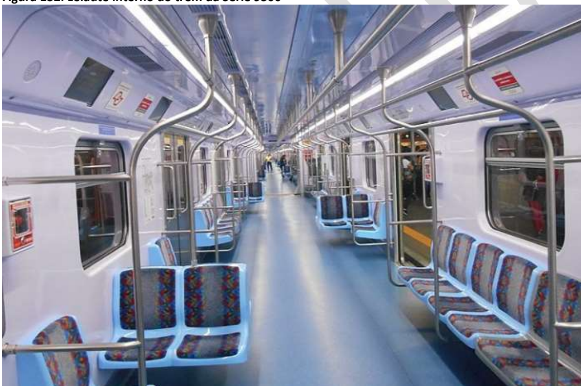
Figura 132: Leiaute interno do trem da Série 9500
